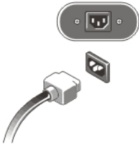
Abbildung 6. Anschließen der Stromversorgung
